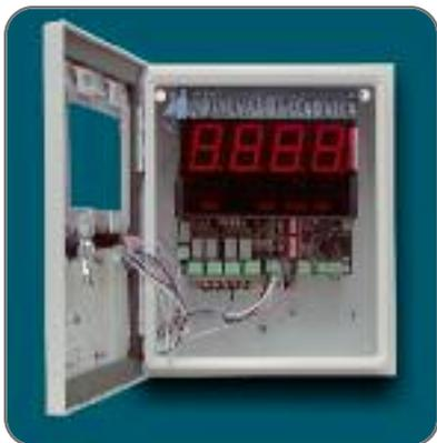
*Los Monitores Toxgard se utilizan en una variedad de aplicaciones industriales o comerciales, gracias a que es fácil de instalar y operar. Simplemente encienda el Monitor de Gas Toxgard II y estará listo para usarse, o utilícelo como un monitor de gas portátil con batería interna opcional. El Monitor Toxgard II de gas combustible sólo necesita conectarse a su sensor remoto.*
